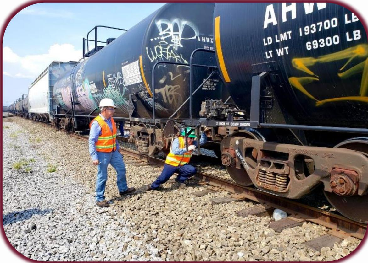
Antes de iniciar un viaje, todos los carros de un tren en una terminal inicial o los que sean agregados en camino, deben recibir una inspección de seguridad. Las inspecciones y pruebas del freno de aire deben ser efectuadas por una persona calificada o por un inspector mecánico calificado.
